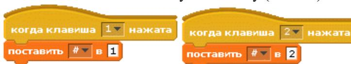
Рис. 43. Скрипты выбора октавы после нажатия на числовую клавишу клавиатуры
